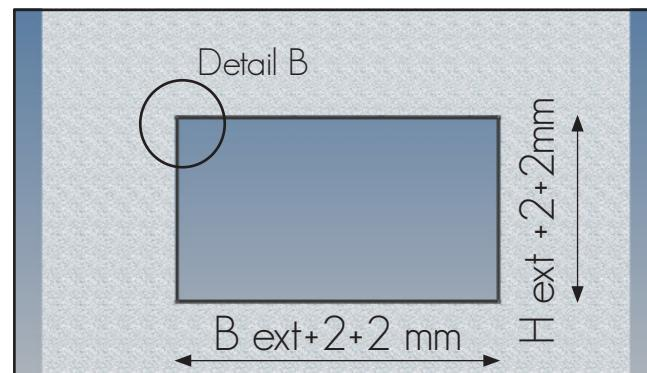
De 4-zijdige kader wordt gebruikt wanneer men de afwerking rondom de kader wilt voorzien. Voorzie een uitzettingsvoeg van 2mm rondom de kader (detail B).
