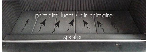
De regeling van de toevoer van verbrandingslucht wordt manueel geregeld. Neem de pook en schuif de regelaar naar rechts om de luchtoevoer te verhogen en naar links om de luchtoevoer te verlagen. Bij een open deur zal de regeling geen effect hebben op het vuur.
