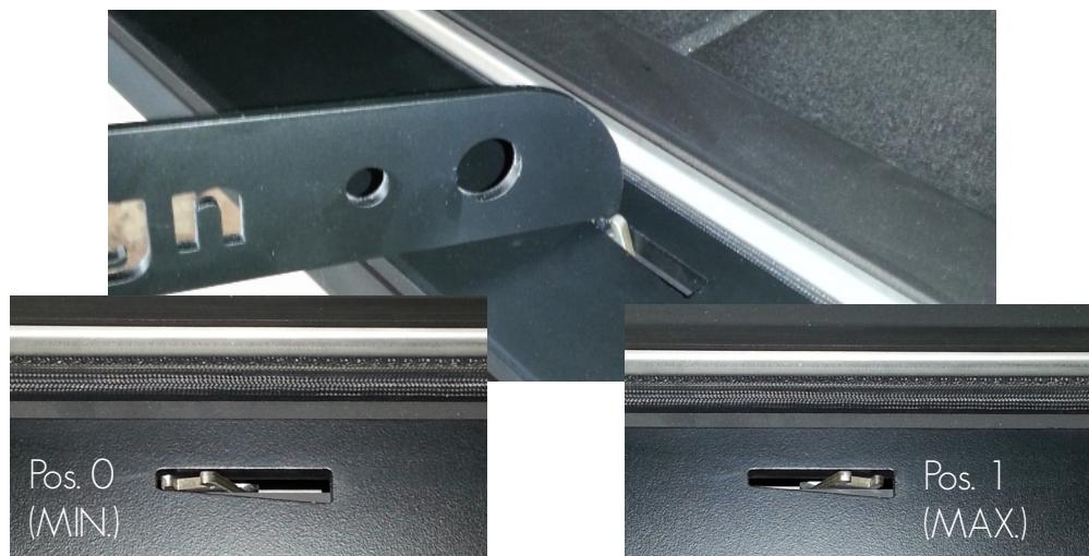
Le réglage de l'arrivée d'air se fait manuellement à l'aide de la main froide . Déplacer le levier vers la droite pour augmenter l'arrivée d'air et vers la gauche pour la diminuer . Quand la porte est ouverte le réglage de la glissière ne donnera aucun effet sur l'allure du feu.
